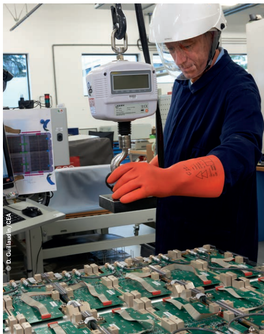
↑ Cette ligne d'assemblage de modules et packs de batteries lithium est un démonstrateur industriel qui permet de faire du prototypage comme de la petite série.
