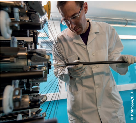
Tressage d'un tube composite répondant aux besoins du nucléaire actuel et de 4° génération.
