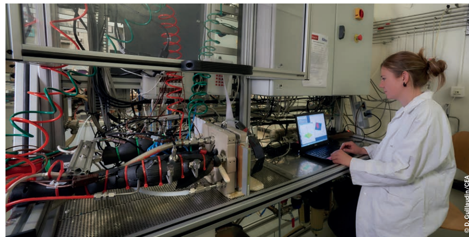
↑ Cartographie des densités de courant lors de l'analyse physico-chimique d'une pile à combustible.
