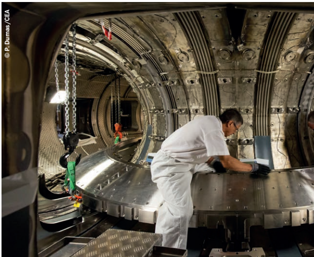
↑ Pose d'un composant du projet West à l'intérieur du tokamak.
