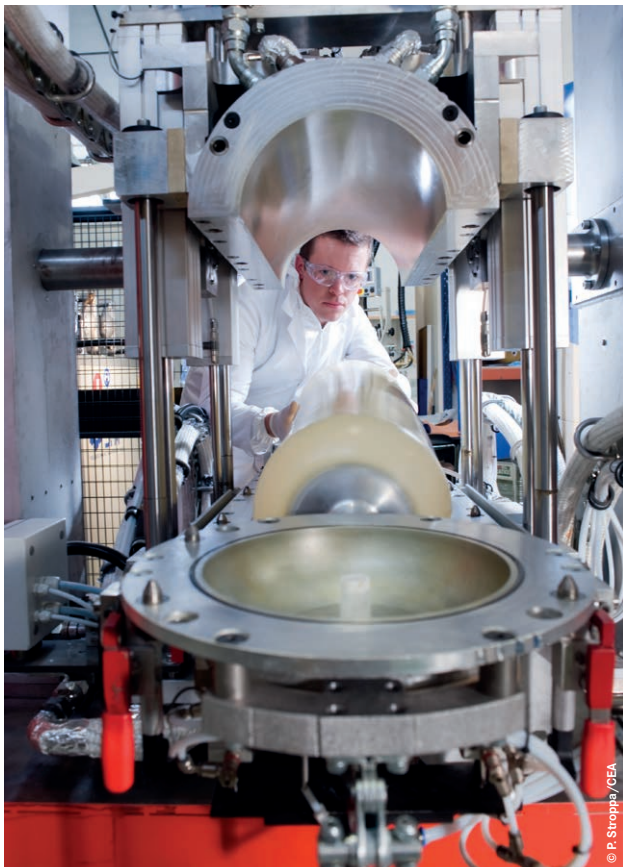
↑ Démoulage d'un liner polyuréthane à l'issue d'un cycle de rotomoulage.
