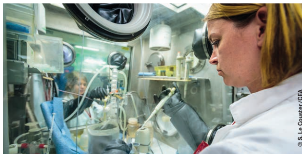
↑ Dissolution de pastilles MOX en boîte-à-gants, avant la séparation par extraction liquide des constituants du combustible.
