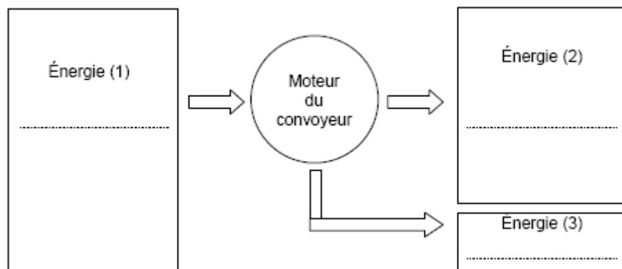
2 Le rendement énergétique du convoyeur a pour valeur : 75 %. Cette machine est prévue pour absorber une puissance électrique maximale de 250 W. Indiquer, en le justifiant, si la puissance électrique  $P_a$ , absorbée par le convoyeur lorsqu'il transporte du raisin dans les conditions décrites ici, est satisfaisante ou pas.
